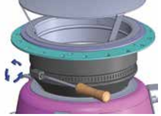
Şekil 12c3 Boğaz lastiği üzerindeki kelepçeyi gevşetiniz.
